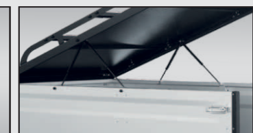
2 zusätzliche Stoßdämpfer für die Montage des Dachzeltes
