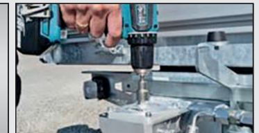
Hydraulikpumpe für Akkuschauberantrieb (serienmäßig)
