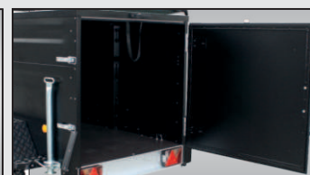
Tür bei allen Koffernmodellen mit geschlossenem Deckel zu öffnen
