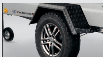
Offroad-Version: begehbare Kotflügel mit Trittleiste
