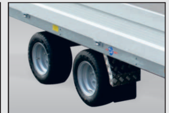
10" - Schwerlastbereifung für niedrige Auffahrhöhe
